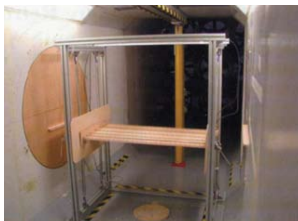
תמונה 9. הבדיקה במנהרת הרוח שבוצעה למודל המפרק המצולב של הגשר המורחב
