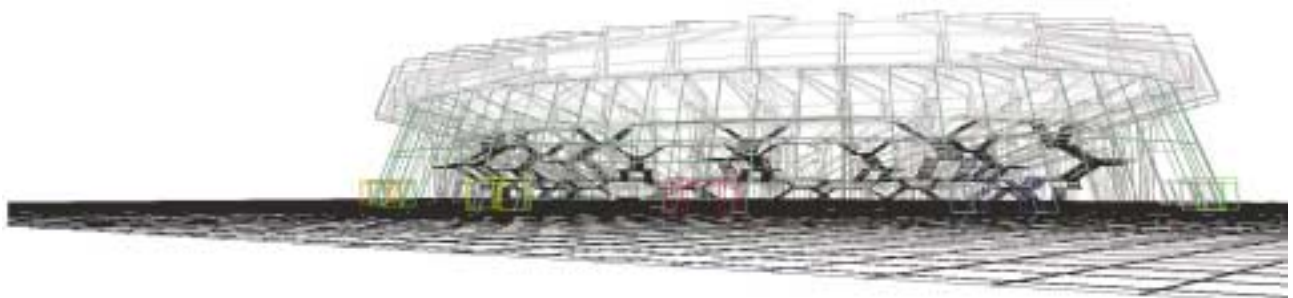
סקיצה המתארת את הרכבת קונסטרוקציית הפלדה החדשה על גבי קונסטרוקציית הבטון הקיימת לשם מינוף הטריבוונה העליונה
