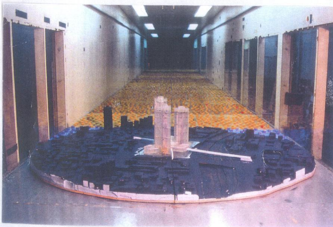
צילום של מודל העבודה בתוך מנהרת הרוח כולל מודל המבנים הסביבתיים שהוכן ב"מעלה הזרם"
